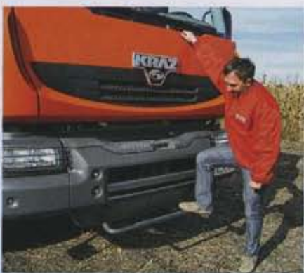
Для доступа к лобовому стеклу служит откидная трубчатая подножка.
