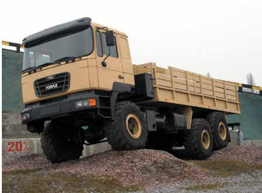
«Лаптежник» КрАЗ-В12.2МЕХ по имени Сержант — перспективный военный вездеход с кабиной Shaanxi (бывшая кабина MAN F2000) и 385-сильным двигателем Cummins ISMe
