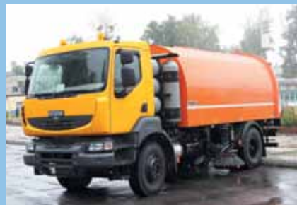
...а в 2011 году адаптировал кабину Renault. На снимке — «уборщик» с газовым двигателем Mercedes
