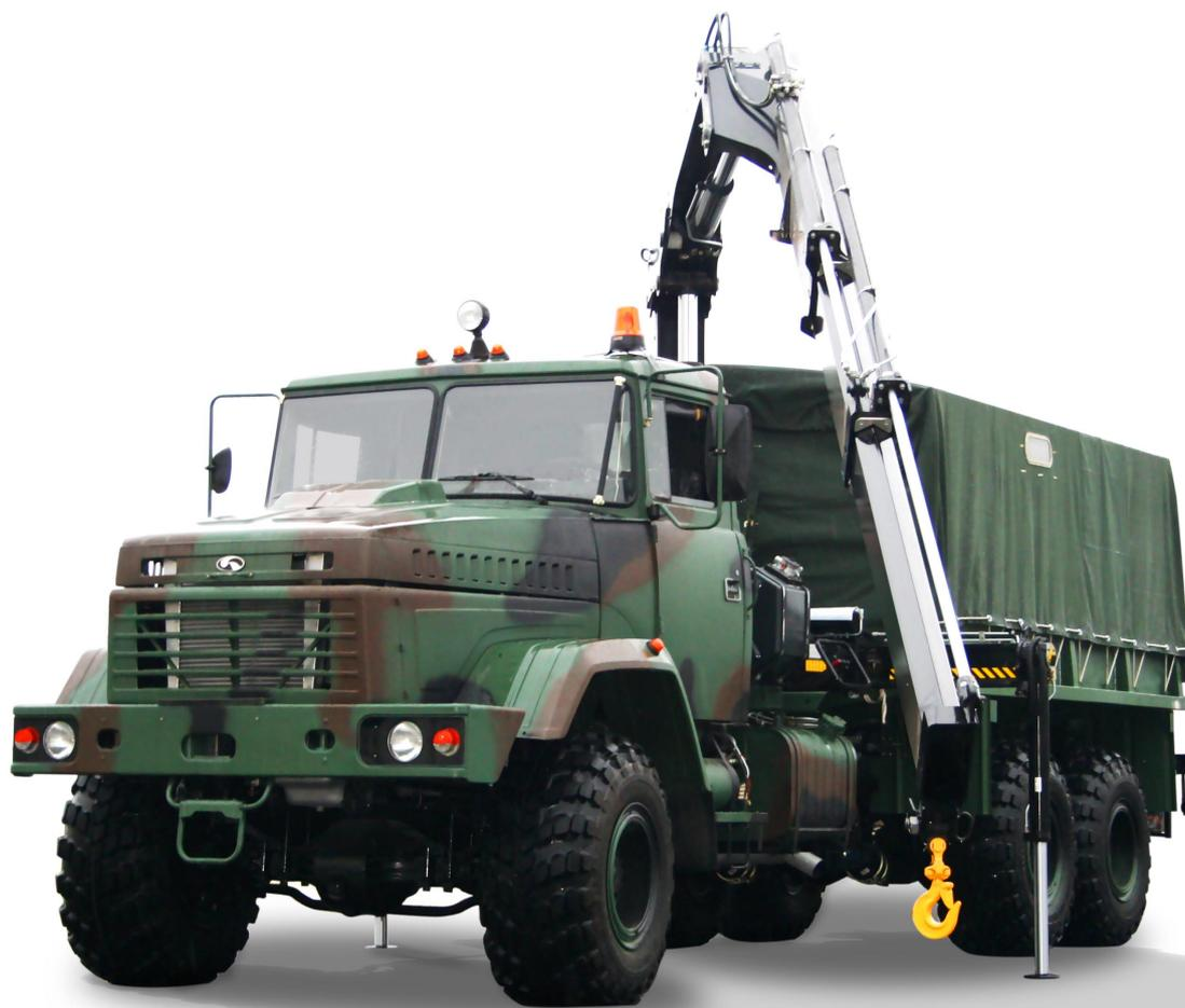
Автомобиль-эвакуатор КрАЗ-6322-047 предназначен для осуществления эвакуации, технического обслуживания и ремонта поврежденной автомобильной и другой техники в полевых условиях. Оборудован краном-манипулятором, устройством для буксировки техники, а также специальным оборудованием для выполнения слесарных, сварочных и других ремонтных работ.
