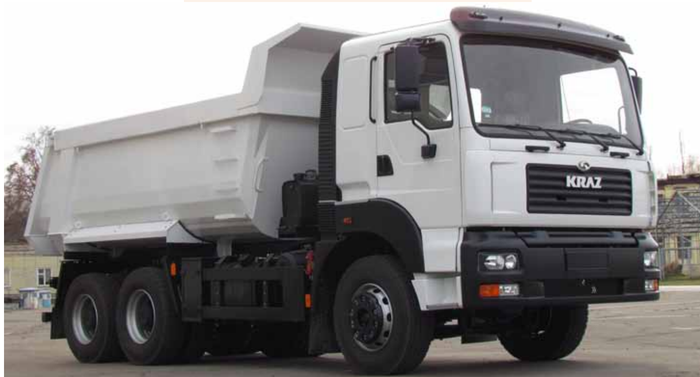
КрАЗ С26.2М грузоподъемностью 26 т с 16-тонной допустимой нагрузкой на мост. Кабина – китайский аналог MAN, силовой агрегат – 400-сильный Weichai WP12 и 9-ступенчатая КПП Fast Gear.
