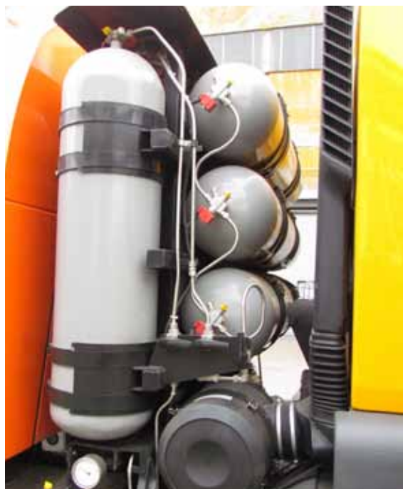
Суммарная емкость размещенных за кабиной Renault газовых баллонов составляет 1155 л.
