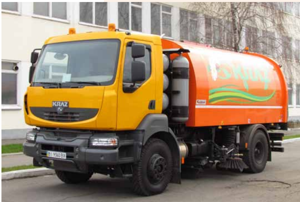
КрАЗ К12.2 с кабиной Renault и газовым двигателем Daimler M906LAG экологического стандарта Евро-5. В прицеле – Европа!
