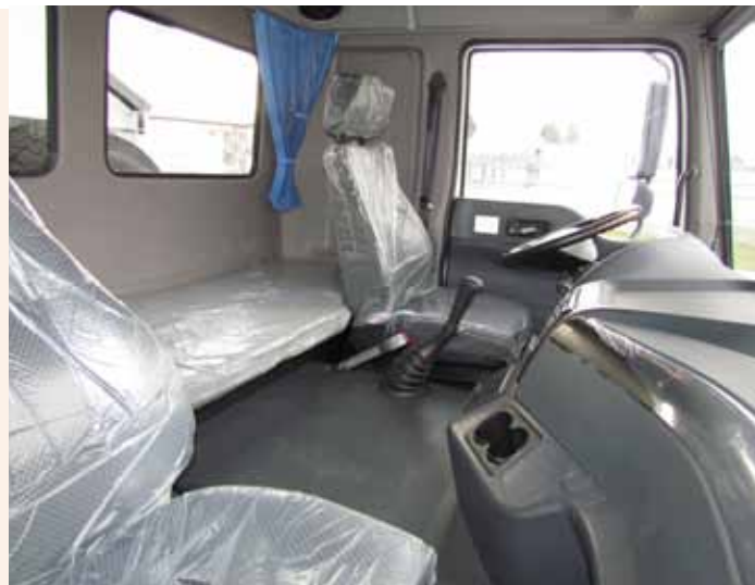
Лицензионная кабина MAN оказалась не совсем привычной для самосвала: за сиденьями расположен спальный отсек, ступеньки прикрыты удлинителем на двери
