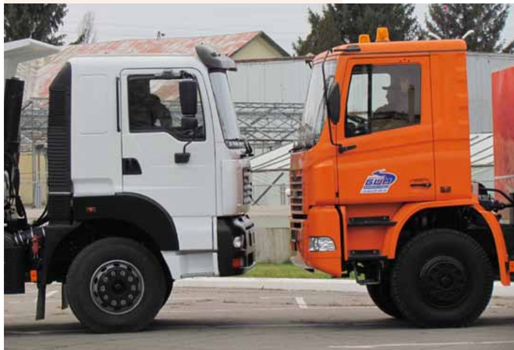
Бескапотные КрАЗы: слева – с китайской кабиной типа MAN, справа – со стенопластиновой кабиной собственной разработки.
