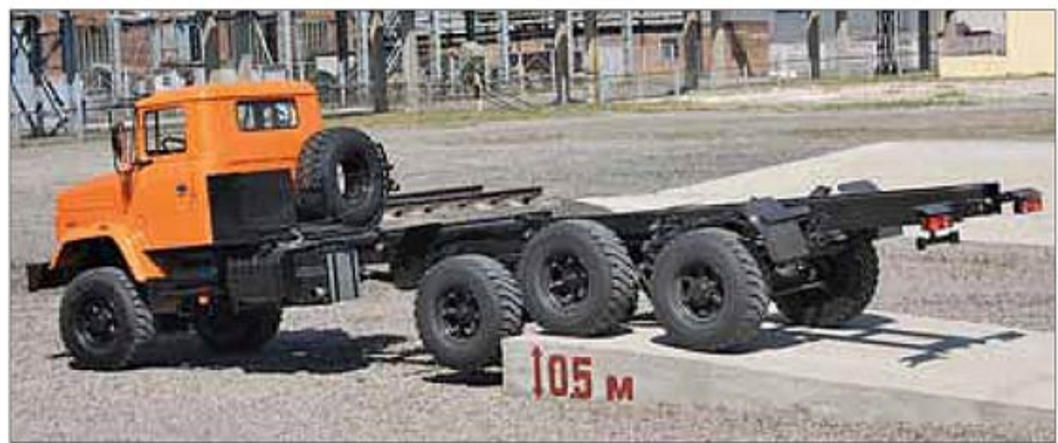
Модернизированное шасси КрАЗ-Н30.0ЕХ, предназначенное под монтаж спецоборудования для нефтедобывающей отрасли
