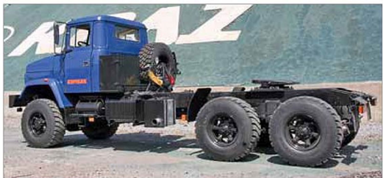
Седельный тягач КрАЗ-Т17.0ЕХ "Бурлак" теперь оснащается 400-сильным мотором вместо 330-сильного
