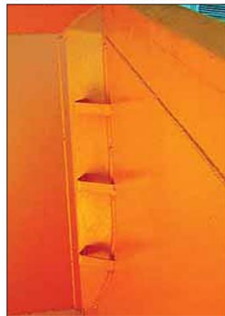
Внутри самосвального кузова сделаны ступеньки. Очень удобно!
