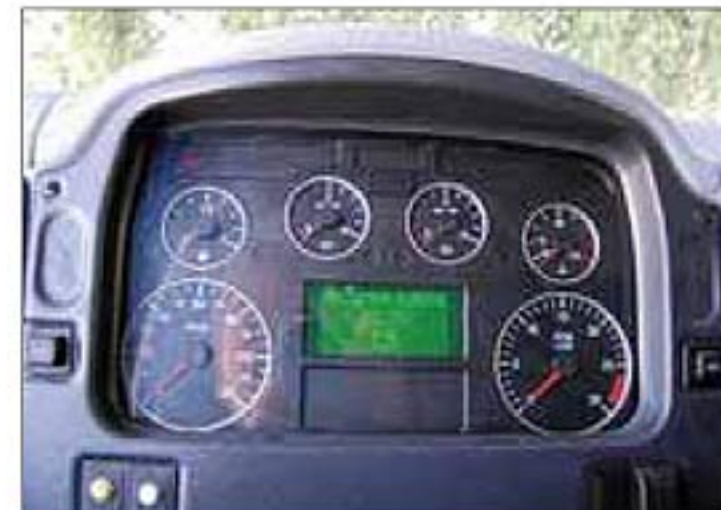
Приборы изготовлены в Витебске, на РУП "ВЗЭП". К самым приборам претензий нет, а вот закрывающее их стекло очень сильно бликует
