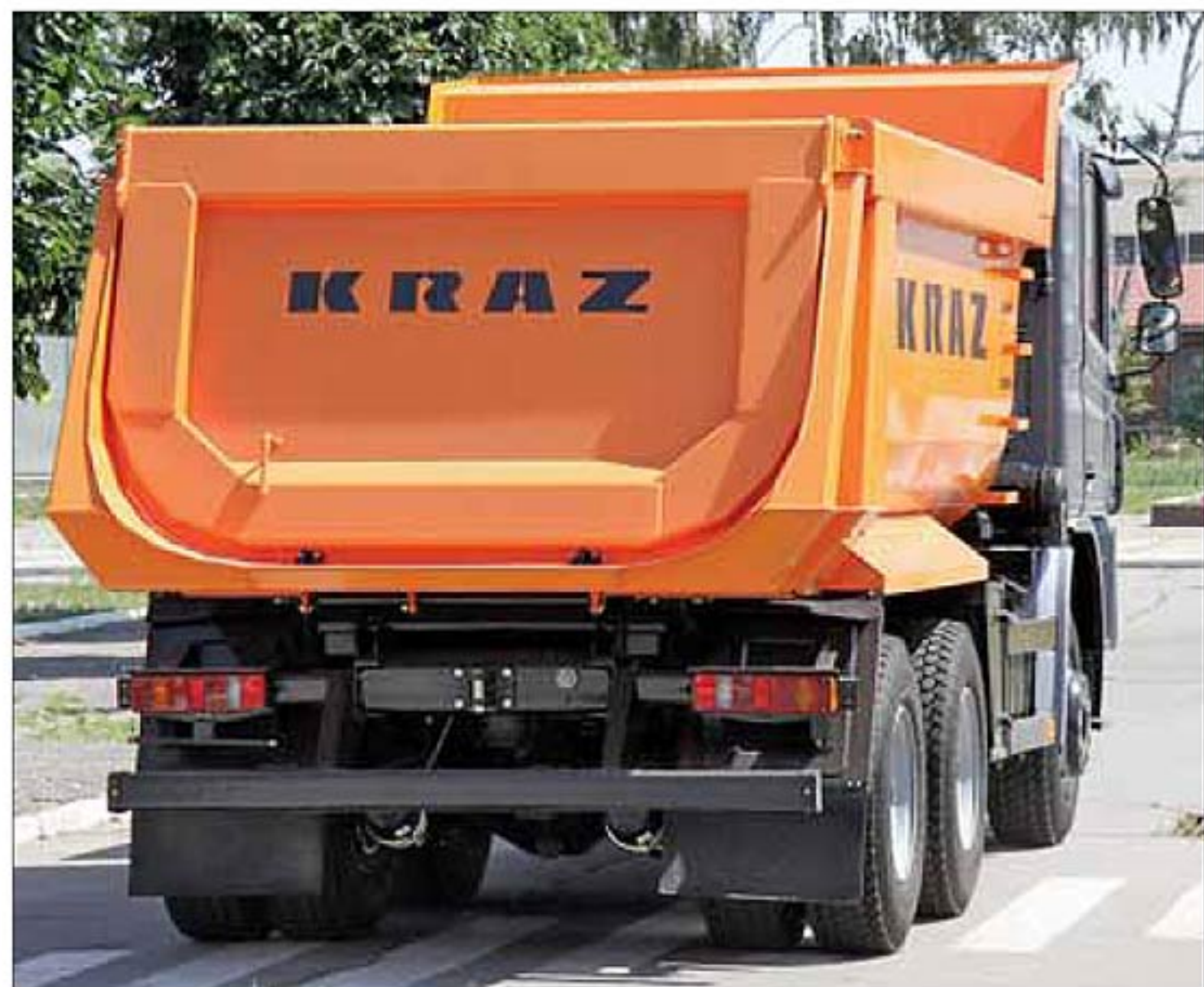
Самосвальный кузов у КраЗ-С20.0 прогрессивной формы - с полуovalным сечением основания
