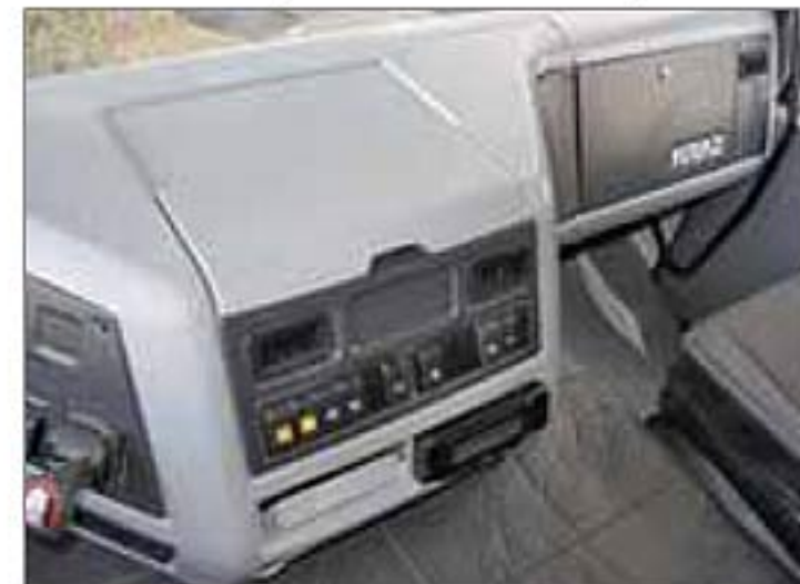
Средней части передней панели придана выступающая форма, благодаря чему появился эдакий столик
