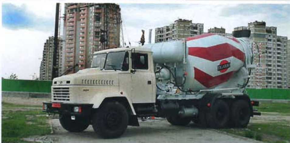
КраЗ 6124 предназначен для приема отдозированных компонентов бетонной смеси, приготовления ее в пути и доставки на строительные объекты
