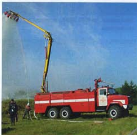
Автомобиль комбинированного пожаротушения АКТ-2/5 (63224)-262.02
