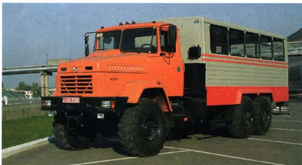
КрАЗ 63221 имеет шасси высокой проходимости с усиленной задней подвеской, может эксплуатироваться по всем видам дорог и бездорожью
