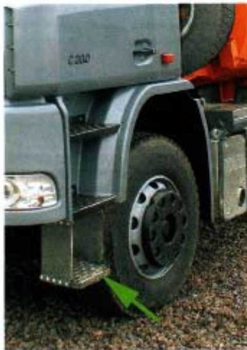
Нижняя гибкая ступенька водительской подножки, сенсорная на резиновых полосках, удобное и практичное жесткое
