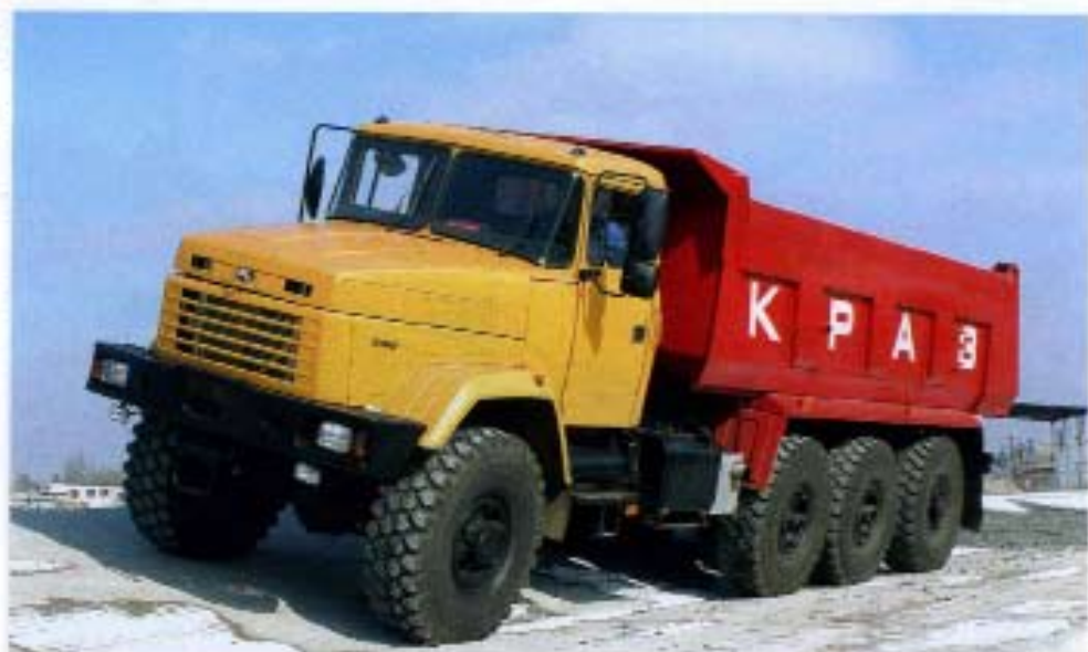
Опытный образец самосвала КрАЗ 7140С6. Машина с осевой формулой 1+3 в серию не пошла, а жал: для необустроенных объектов такая оплошность была бы в самый раз
