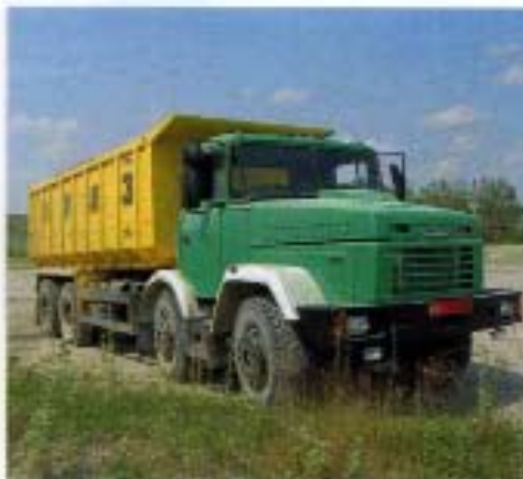
Представитель семейства кременчугских четырехосных машин самосвал КрАЗ 7133С4 с двумя передними рулевыми колесными парами (2+2). Грузоподъемность облегченного кузова 15,2 т, объем 20 м 3
