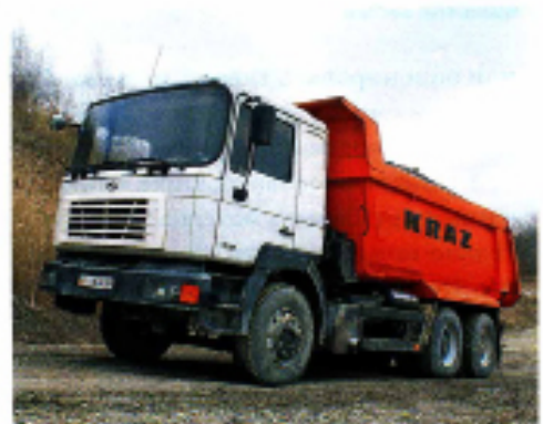
Так выглядел первый опытный образец бескапотника КраЗ 7238С4 с кабиной модели F2000 от автомобиля MAN. Тест-драйв самосвала в феврале 2009 г.
