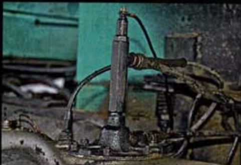
Для подогрева топлива в баке применена свеча накала от предпускового подогревателя КамАЗа
