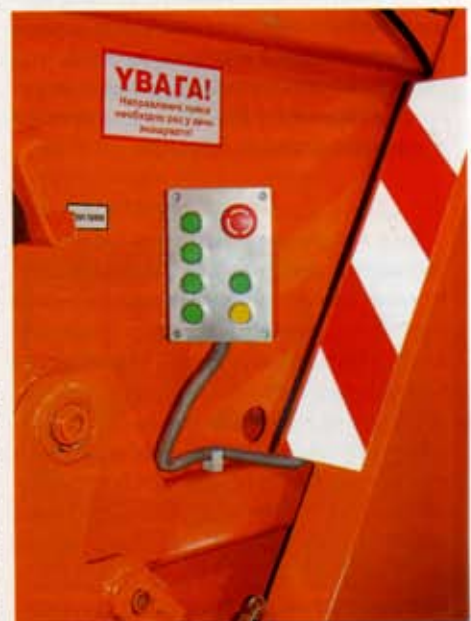
Пост управления прессовочной камерой над задней подножкой с правой стороны установки
