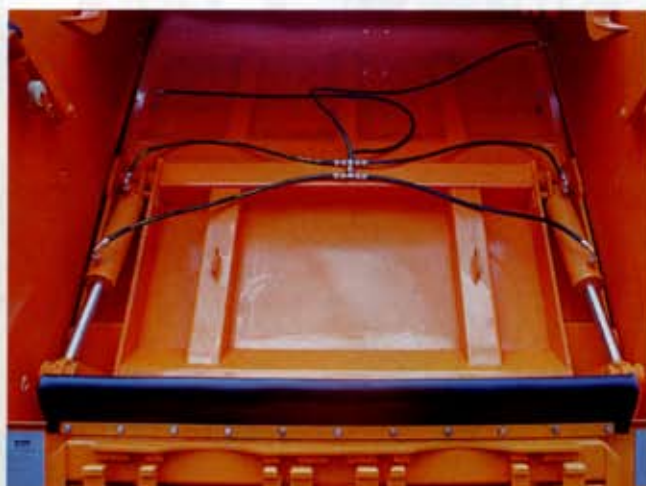
Узел загрузки/выгрузки ТБО оснастили не только надежной гидравликой, но и системой защиты окружающей среды от протекания жидких компонентов прессования
