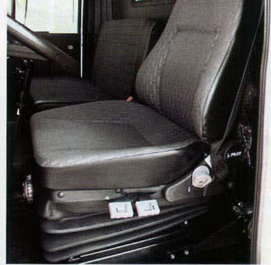
Комфортабельное поддресоренное кресло Pilot с регулировкой наклона подушки и изменяемой жесткостью.
