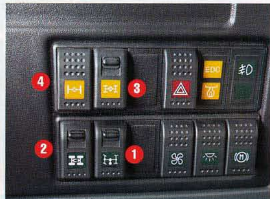
Удобные кнопки управления коробкой отбора мощности 1 , подъема кузова 2 и блокировок межосевого и межколесного дифференциалов 3 , 4 .
