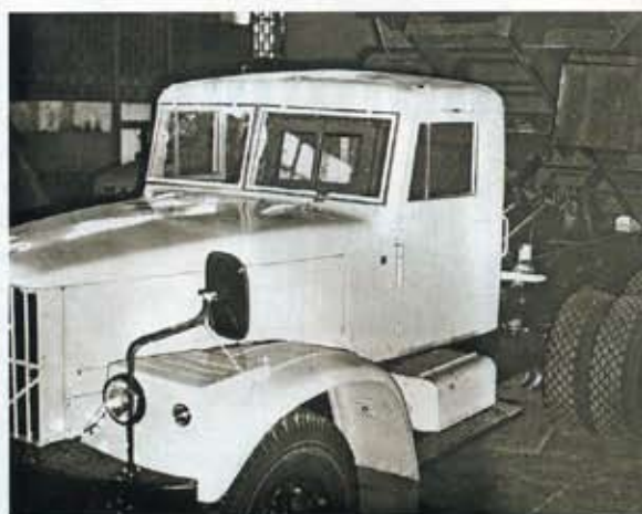
Попытка замаскировать свинцовую капсулу, накрыв её стандартной кабиной. Но от этого варианта пришлось отказаться
