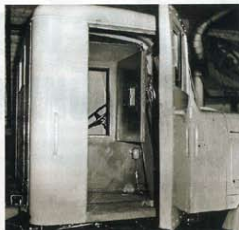
Попытка замаскировать свинцовую капсулу, накрыв её стандартной кабиной. Но от этого варианта пришлось отказаться
