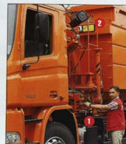
◀ Кран-манипулятор имеет два пульта управления: с земли 1 и с верхней площадки 2, позволяющей наблюдать за размещением груза в кузове.
