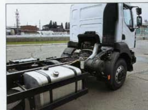
▲ Новый алюминиевый бак оборудован электронным датчиком запаса топлива.
