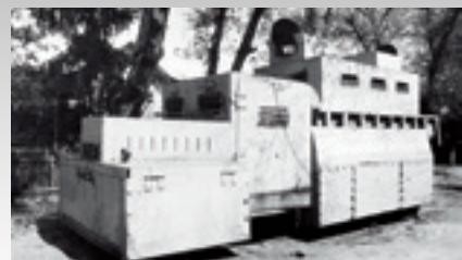
Импровизированный броневик на базе самосвала КрАЗ-256Б, построенный во время Приднестровского конфликта в 1992 году.
