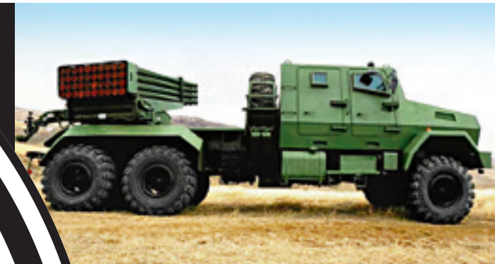
Бронированный комплекс РСЗО «Град», созданный в Грузии в 2012 году на базе КрАЗ-6322.
