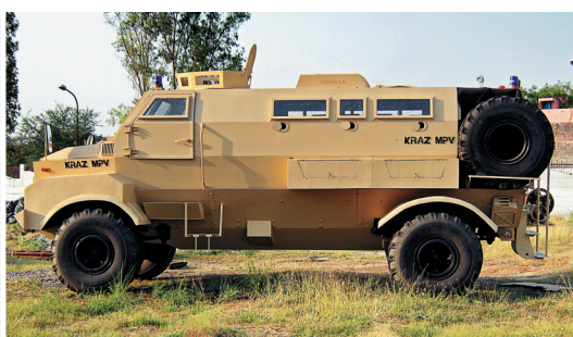
Пропорции индийского и арабского броневиков на базе КрАЗ-5233НЕ схожи, однако у Пантеры больше длина «салона» и предусмотрена запасная дверь в левой боковине
