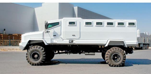
Пропорции индийского и арабского броневиков на базе КрАЗ-5233НЕ схожи, однако у Пантеры больше длина «салона» и предусмотрена запасная дверь в левой боковине
