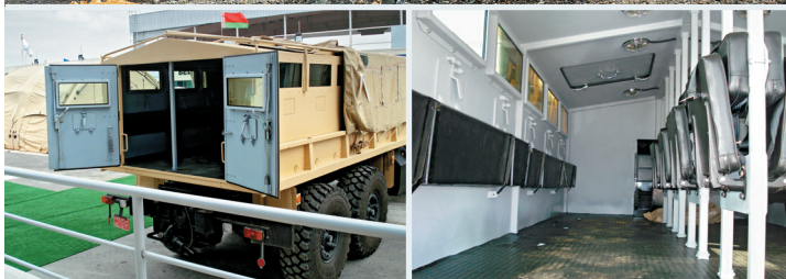
Raptor канадской компании «Streit Armored Group» и его обитаемый бронированный модуль, спрятанный под тентом
