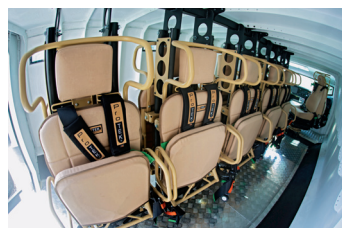
Сиденья для личного состава подвешены вдоль осевой линии машины спинкой к спинке
