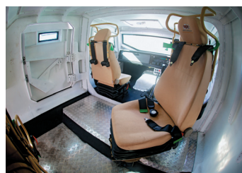
Сиденья водителя и командира Пантеры – с пневмоподвеской и 4-точечными ремнями
