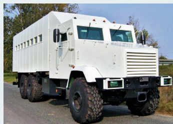
Приднестровский Guntruck, кустарно изготовленный из самосвала КраЗ-256Б (фото 1992 г.)
