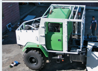
▲ Бронеавтомобиль итальянской компании «Vehicle Engineering» и его бронекабина в стадии сборки
