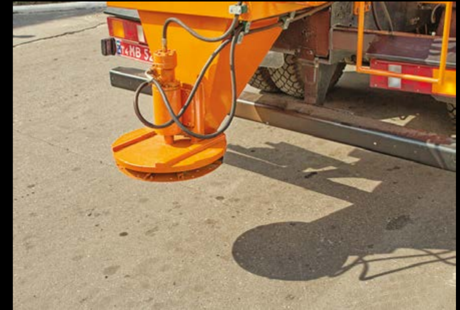
Солерозкидач призначений для посипання інертними матеріалами або антижеледними реагентами з можливістю змочування сольовим розчином
