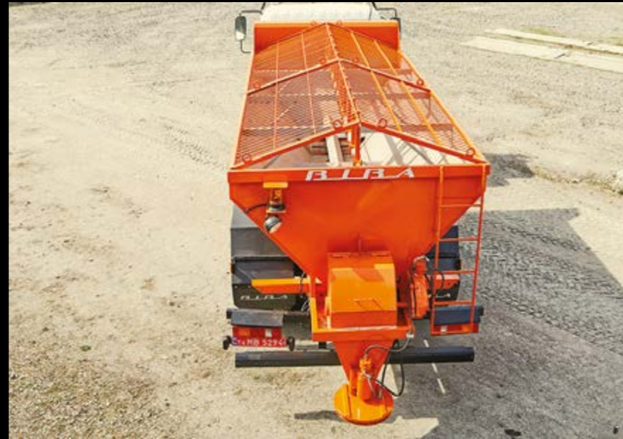
Солерозкидач призначений для посипання інертними матеріалами або антижеледними реагентами з можливістю змочування сольовим розчином
