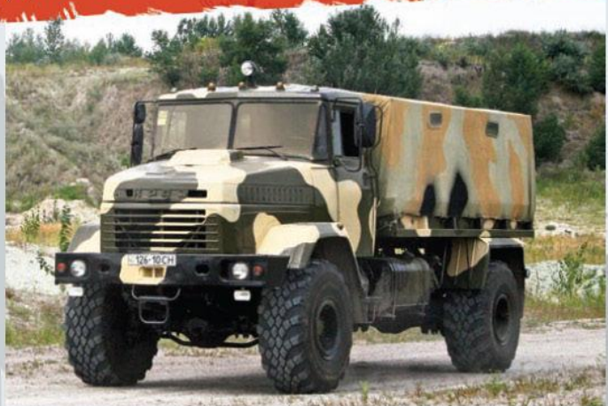
В основе Shrek'a – полноприводный двухосный грузовик KrAZ-5233BE «Спецназ»
