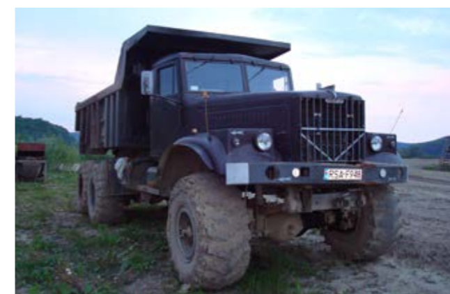
Самосвалы на базе КраЗ-255Б сам завод не изготавливал, но число самосвальных «конверсий» не так уж и мало. Этот экземпляр рабо-
