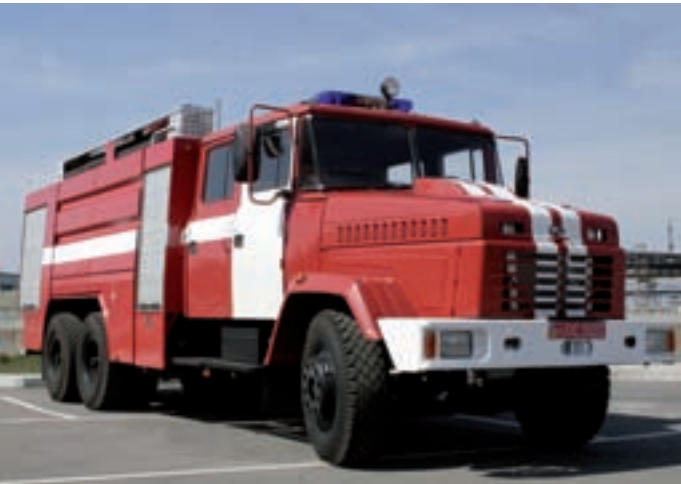
Новая пожарная автоцистерна АЦ-60 на шасси автомобиля КраЗ-65053. 2009 г.
